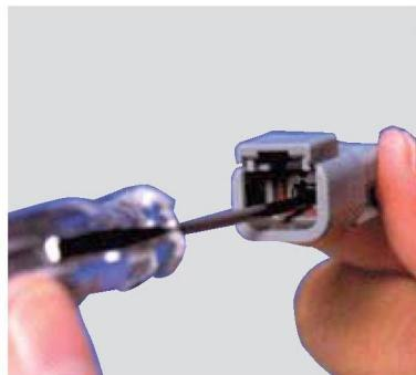
2. Чтобы снять контакты, аккуратно потяните провод назад, в то же время освободив "стопорный палец", отодвинув его от контакта с помощью отвертки.
