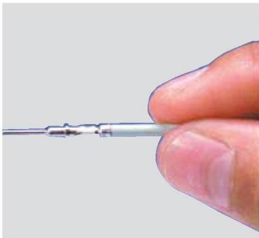
1. Возьмите обжимной провод за основание (его длина должна быть ~25 мм)
